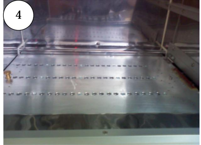
箱内部の底には取り外しができるステンレスパイプとアルミ L チャンネルで作成したスノコが置けるようになっていて、スノコは上部に約10cm間隔で設置できるように、棚受けを両側壁に設けた。
