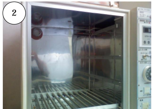
前扉を開けた状態：扉の右側が操作パネル、ステンレス板の継ぎ目はバスボンドでシール。
